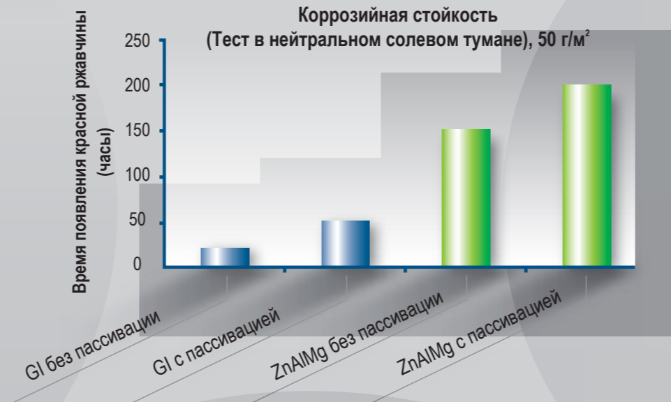
СРАВНЕНИЕ КОРРОЗИОННОЙ СТОЙКОСТИ (После 150 часов в солевой камере - НСС TEST)
